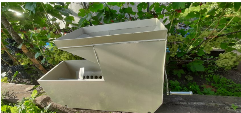
Рис. 22. Дробилка с гребнеотделителем (Лоза)
